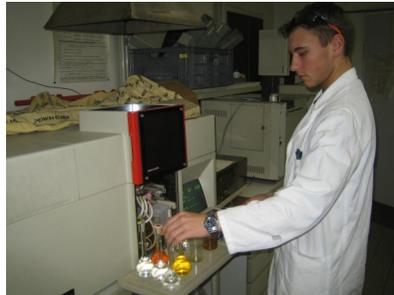
**Analyse von Schwermetallen mit einem Atomabsorptionsspektrometer**
